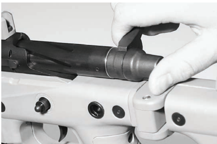
Push the cocking handle forward. Poussez le levier d'armement en avant. Empuje el mango del amartillador hacia delante.
